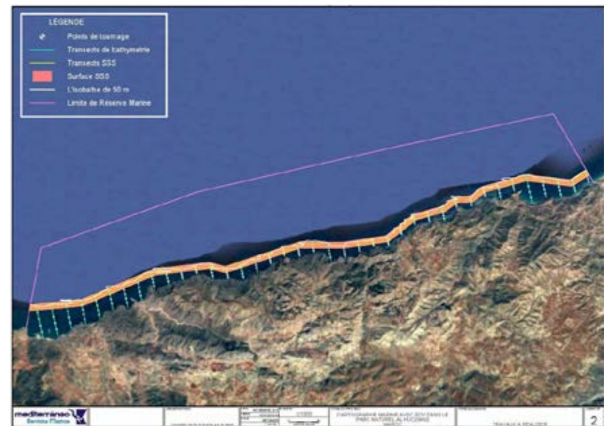
Figure 5 Réseau de prospection pour les enregistrements ROV, les levés bathymétriques et le Sonar à Balayage Latéral dans la partie marine du PNAH.
